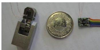
Bild 2. PCB verwendete für Spannungsmessungen und Greifer
